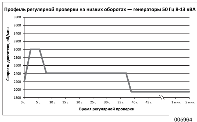
Рис. 3-7. Профиль регулярной проверки на низких оборотах
