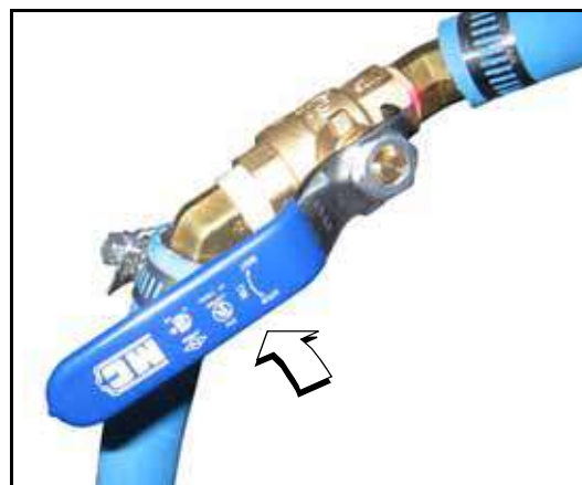
Рис. 5-19. Запорный клапан (изображен в открытом положении)
