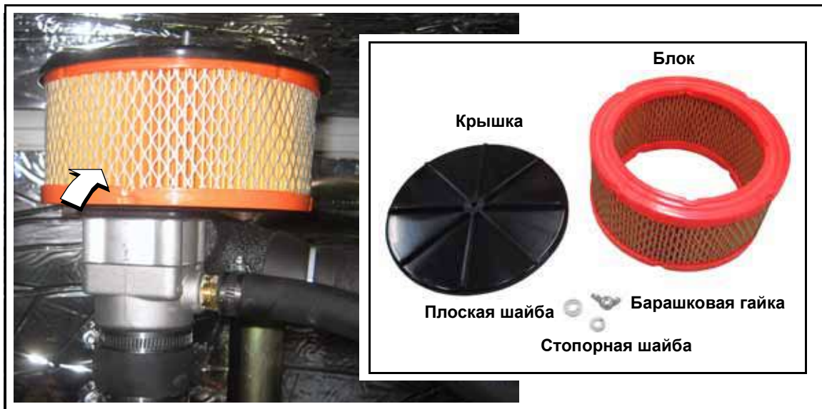
Рис. 5-13. Крышка воздухоочистителя и блок фильтра
